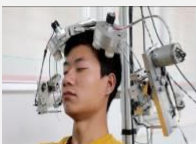
头部清洗按摩装置完成头部的清洗、揉搓和按摩功能
